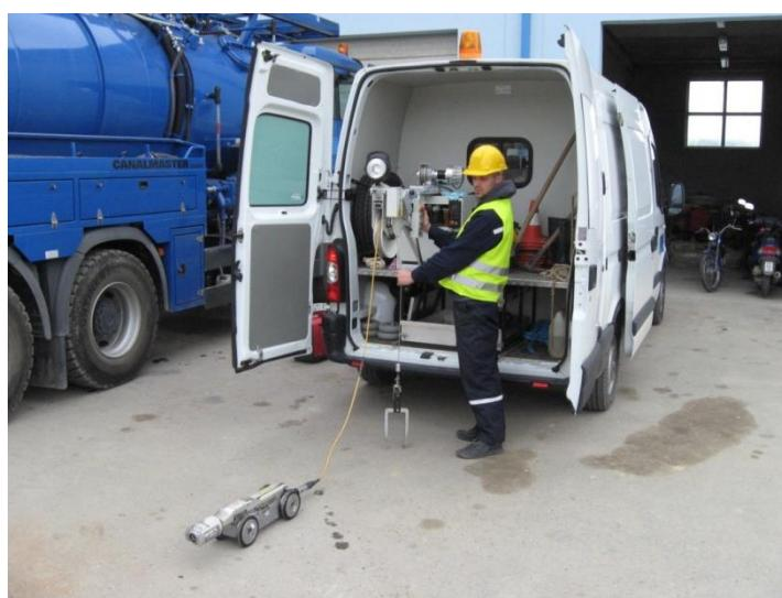
**Oprema za CCTV inspekciju kanalizacijskih cjevovoda**
